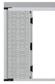
4. Τέλος, στερεώνουμε τα δύο πλαστικά συγκράτησης των οδηγών, χρησιμοποιώντας το μικρότερο πλαστικό για τον κάτω οδηγό και το μεγαλύτερο πλαστικό για τον επάνω οδηγό. Αφού τα στερεώσουμε, στην συνέχεια βιδώνουμε τα δύο κομμάτια οδηγών στο επάνω μέρος στο άνοιγμα μας και τους κάτω απλά τους συρταρώνουμε στο εξάρτημα της ανάκλησης.
